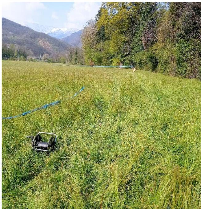
**Foto 1 - Stendimento sismico MASW.**
